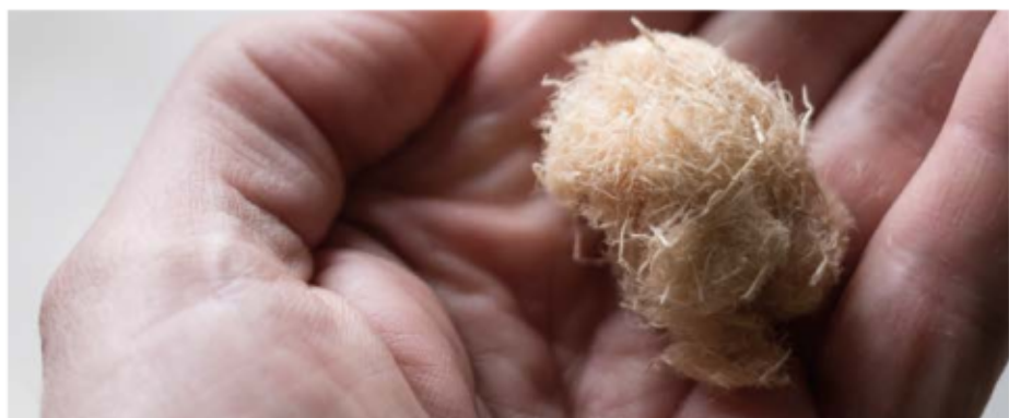
Le bois sous toutes ses formes dans la construction biosourcée : ici, laine de bois pour l'isolation. Sylvain Gaudin © CNPF.
